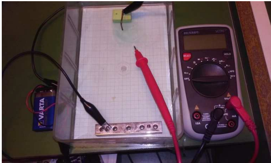
11. Ekvipotenciális vonalak kimérése elektromos térben
